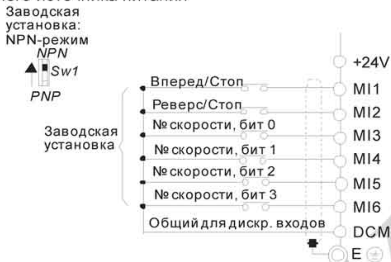
Рисунок 7. Выбор логики управления дискретными входами микропереключателем Sw1. А. NPN-режим без внешнего источника питания
